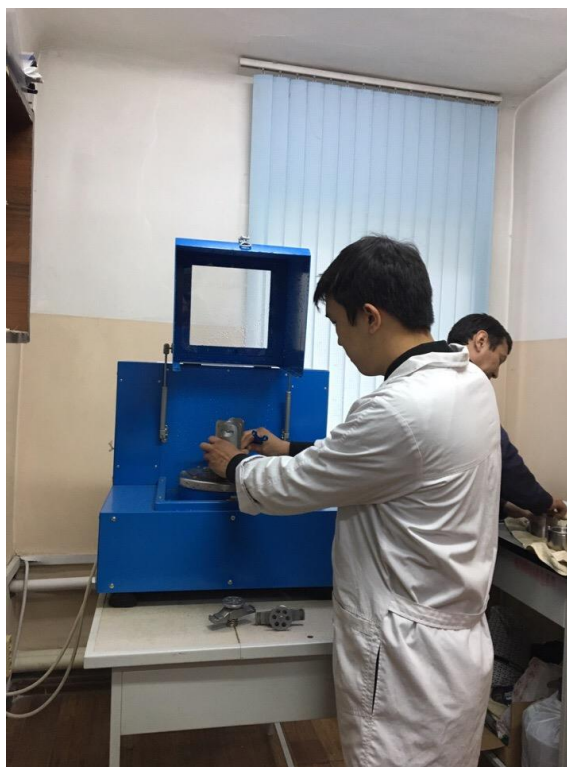
Рисунок 7. Синтез кремнефосфатных материалов на шаровой планетарной мельнице типа «Агитатор 2S»
