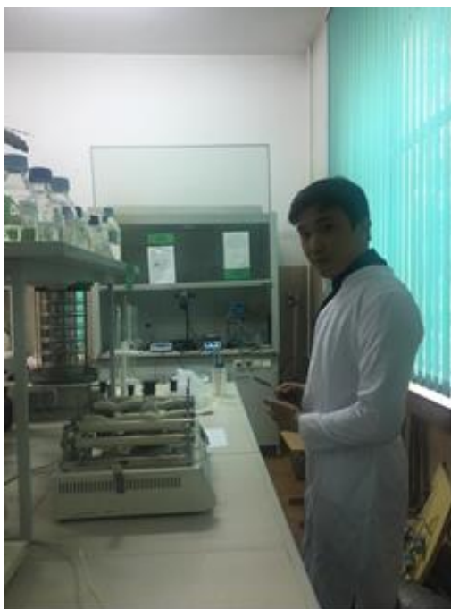
Рисунок 10. Исследование растворимости синтезированных продуктов с использованием Шейкера
