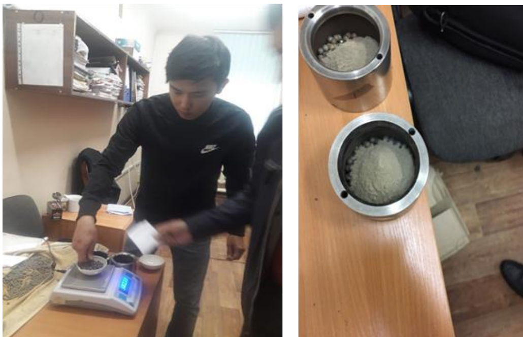
Рисунок 8. Подготовка исходной смеси к синтезу
